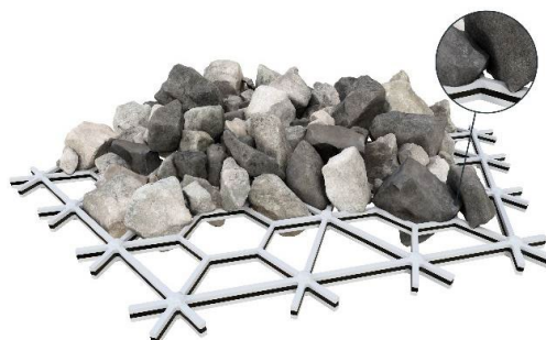
Rysunek 1: Struktura oczek georusztu zazębia się z ziarnami kruszywa. Ściśnięte białe warstwy poddają się pod naciskiem ziaren.
